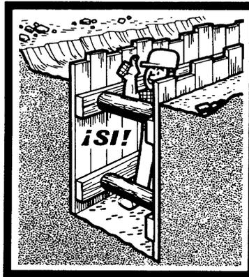
La entibación debe realizarse según se va progresando en la excavación, de forma que cualquier operario que participe en los trabajos este siempre protegido.
