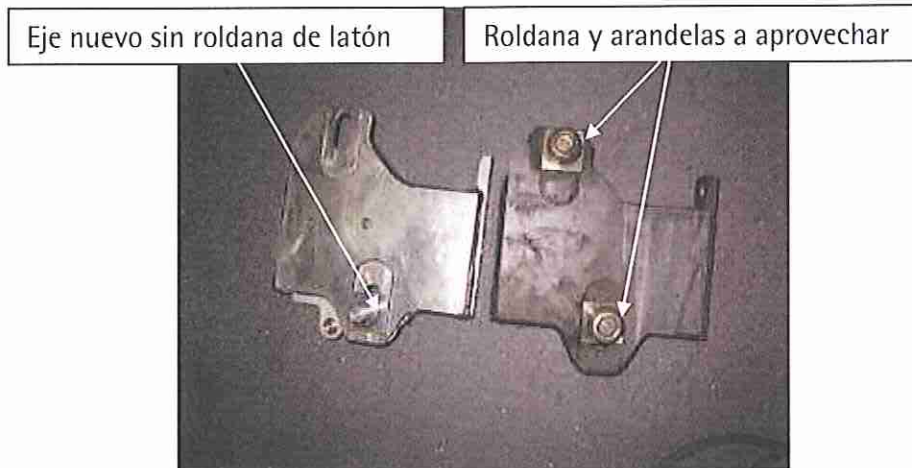
Foto 8: Pre montaje roldanas, y ejes en eje condena nuevo.
