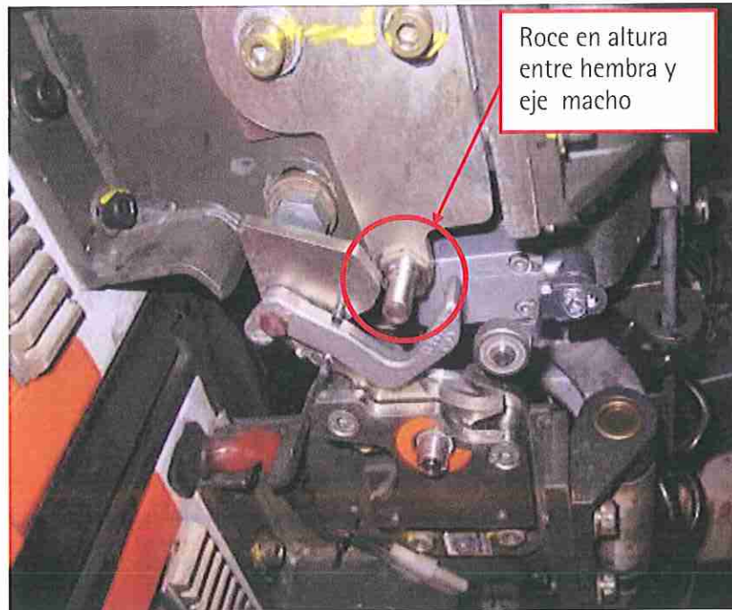
Foto 4. Ajuste límite. Roce en altura entre eje macho y gancho hembra. Roce entre gancho y hembra.
